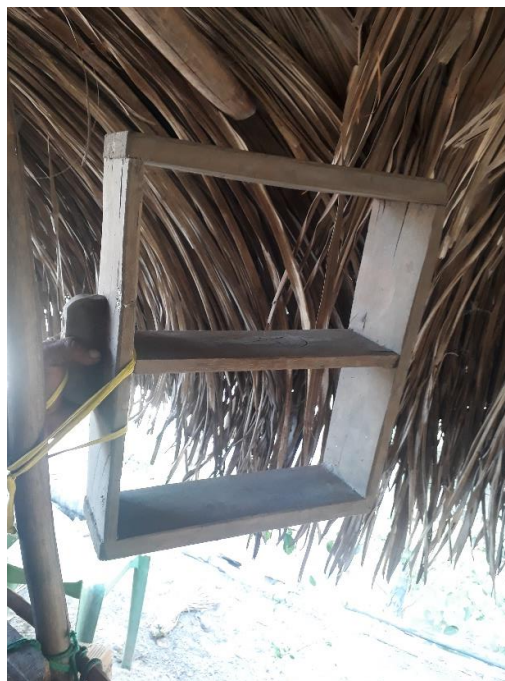
Fig. 03: Forma para produção do adobe. Fonte: Arquivo pessoal de expedição, 2019.
